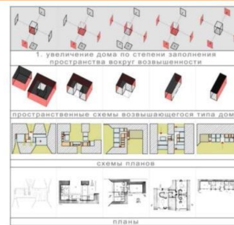
Схема увеличения возвышающегося типа заглубленного дома по степени заполнения пространства вокруг возвышенности
